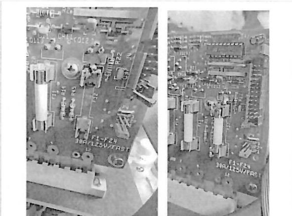
Se encontró daño en un porta fusible recalentado, el fusible también estaba dañado, por corto en un SCR se efectuaron las reparaciones necesarias y se pone en operación.
